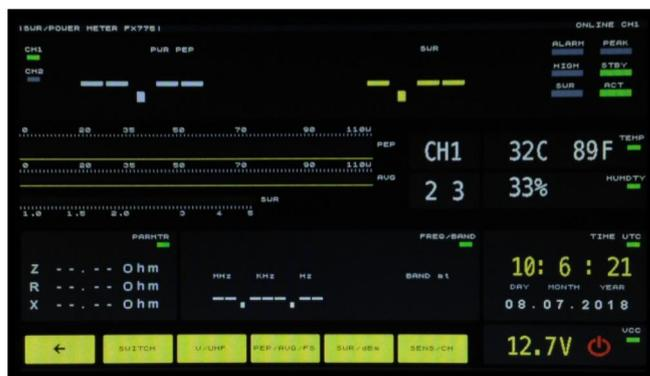
**MENU WATTMETER:** dove e' possibile visualizzare la Potenza PeP(picco), AVG(media), tutti paramenti SWR ,R,Z,X, frequenza operativa,banda,tensione alimentazione temperatura/umidita' interna data ora selezionare il sensore e switch di antenna.
