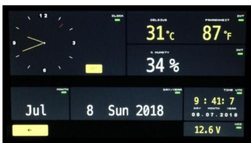
**MENU CLOCK:** Lo strumento possiede all'interno un chip dedicato all'orologio di sistema e calendario perpetuo. E' possibile settare l'ora attraverso il sotto menu SET. E' possibile visualizzare anche la temperatura e umidita' in % dello strumento e gli altri parametri operativi. La sonda e' posizionata sul lato posteriore in corrispondenza dei fori di areazione.
