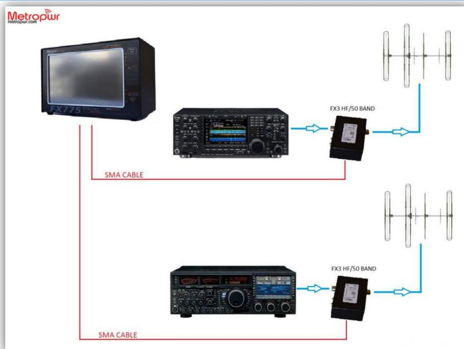
**Collegamento FX7/FX43:** schema di collegamento per gestire banda HF/50MHz. Attraverso i cavetti SMA e' possibile interfacciare due Coupler FX3/5 e attraverso il bus EXP bus si possono collegare in serie gli altri due FX7 optional. In questa configurazione l'FX773/5 puo' gestire due radio e antenne.
