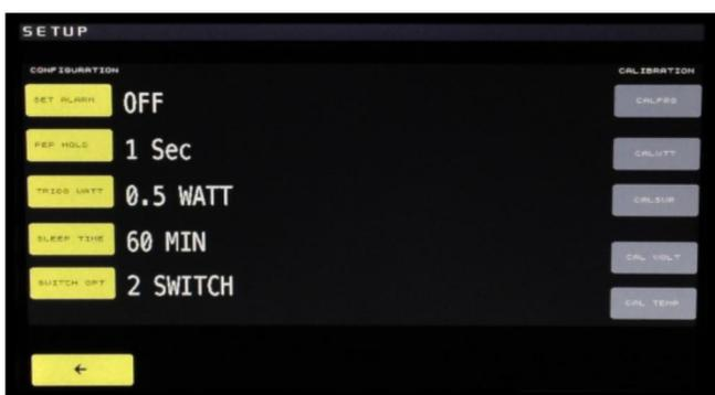
**MENU SETUP:** Attraverso questo menu e' possibile settare l'allarme SWR, tempo in secondi visualizzazione potenza PeP, Trigger watt potenza minima per misure, Sleep Time tempo per standby, Switch opt numero di switch collegati. E tutte le calibrazioni di frequenza, potenza, swr, su tutte le bande operative, in piu' tensione di alimentazione e temperatura.
