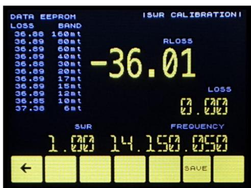
**CALSWR:** attraverso questo menu e' possibile ricalibrare la parte SWR. Collegare la radio e impostare 10W trasmettere non collegando nessuna antenna. Attenzione operazione potrebbe danneggiare i finali della radio quindi dare un piccolo colpo di portante e contemporaneamente premere tasto SAVE. Ripetere questa operazione su tutte le 11 bande.
