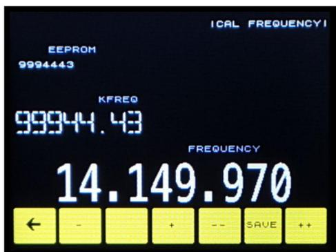
**CALFREQ:** attraverso questo menu e' possibile calibrare il frequenzimetro interno. Trasmettere con la radio a 10MHz e impostare attraverso i tasti +/- ++/-- la corretta visualizzazione della frequenza a 10.000.000 MHz alla fine memorizzare parametro attraverso tasto SAVE.
