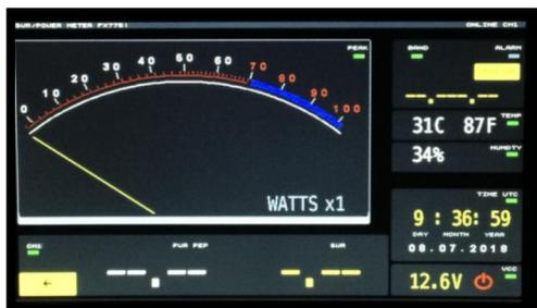
**MENU SMETER:** come menu Wattmeter ma misura con indice virtuale analogico. Lo strumento virtuale e' autoranging con fattore di moltiplicazione X . Esempio se l'indice indica 10 e lo strumento indica X100 la potenza misurata e' di 1000 Watt PeP.
