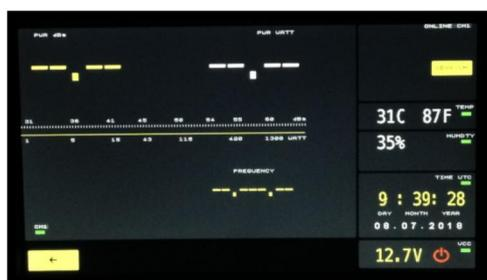
**MENU dBmeter:** qui sono riportate le misure di potenza in dBm anche in formato grafico fino a 1500 Watt. Con possibilita' di selezionare anche sonda operativa CH1/2.
