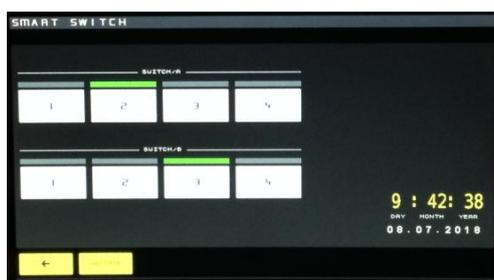
**MENU SWITCH:** attraverso questo menu vengono gestiti gli switch di antenna FX7. Se sono collegati 2 switch vengono visualizzate due file di tasti, una per lo switch A e l'altra switch B. Se si collega un solo FX7 verra' visualizzata solo una fila di tasti. Il Led verde indica lo switch attualmente selezionato. Le impostazioni sono memorizzate e conservate anche dopo lo spegnimento.
