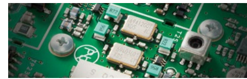
Filtri a tetto da 3 kHz e 15 kHz
