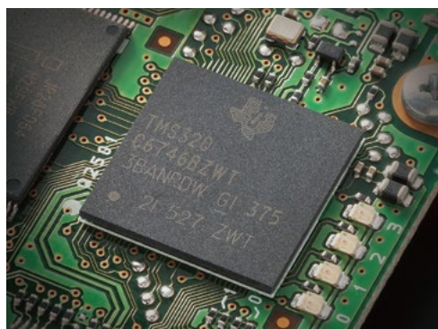
DSP a virgola mobile ad alta velocità a 32 bit
