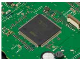
For IF DSP, transmitter ADSP-21363 clock @332MHz
