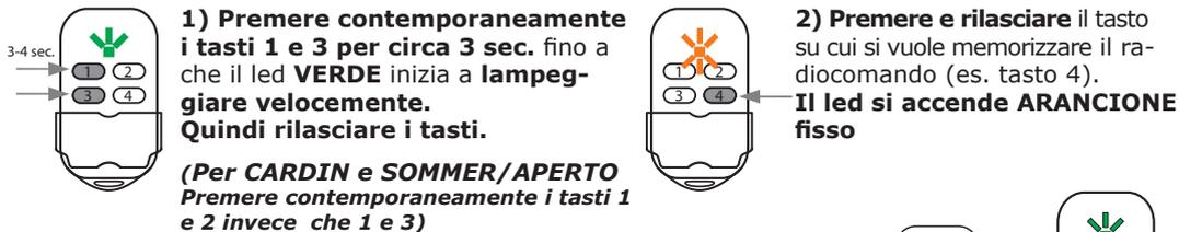
**3)** Posizionare il radiocomando originale ad una distanza di circa 10 cm e premere il tasto che si vuole duplicare fino a che il led del Magiko emette alcuni lampeggi VERDI veloci seguiti da 6 lampeggi lenti.
