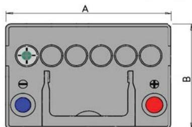
**BATTERIA** senza manutenzione, costruita con lega Pb/Sb a basso contenuto di antimonio secondo Norma DIN
