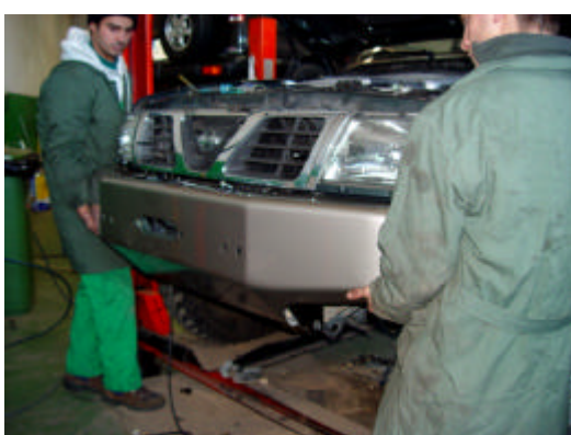
13- Apontar o pára-choques e segurá-lo com os parafusos (M12) do guia do cabo, ou suportes de manilha.
