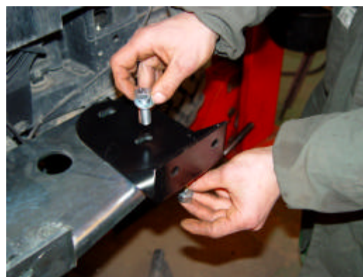
8- Apontar os parafusos (M12) nas fêmeas, de modo a segurar a mesa e os suportes de manilha nos suportes aparafusados às longarinas.
