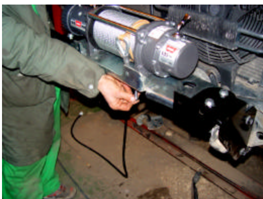
11- Apertar todos os parafusos dos suportes da estrutura.
