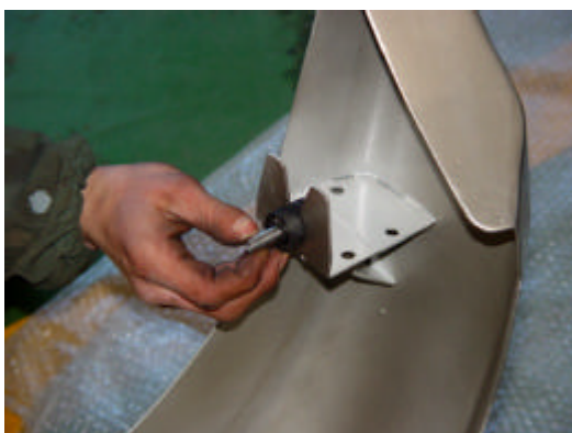
12- Nos suportes do pára-choques, colocar a borracha de aperto. No seu interior colocar o casquilho metálico.
