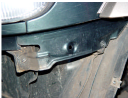
13- Colocar o parafuso (M8) na furação original e passar pelo casquilho, colocado na borracha de aperto.
