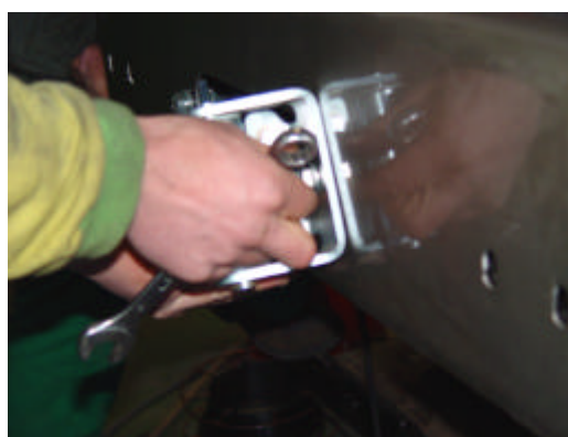
15- Apontar e apertar o guia do cabo do guincho e os suportes de manilha, com parafusos M12.
